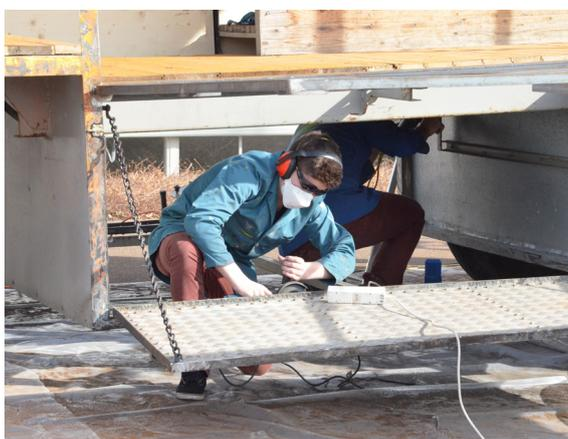
Die bestehende Farbe muss abgeschliffen werden. Schnell wird klar, dass der Wagen bereits ca. 5mal neu gestrichen wurde. Leider aber nicht sehr fachmännisch, was für uns bedeutet, dass wir bei den Schleifarbeiten besonders exakt arbeiten müssen, damit die neue Farbe auch sicher gut haftet.
