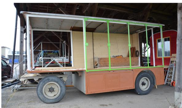
Das Resultat nach zwei Arbeitstagen lässt sich sehen. Das alte Gestell ist Grundiert, Klappwand, Unterboden und Fahrgestell bereits mit den Endfarben lackiert.
